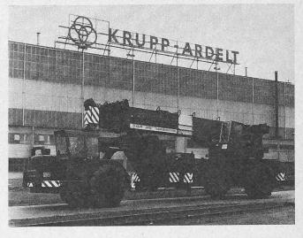
Hydraulikpumpen gekoppelt. Sie leiten den Öldruck weiter an Hydraulikmotoren im Krantriebwerk, Hubwerk, Drehwerk und Teleskopwerk sowie zum Wippen des Auslegers in Wippzylinder. Zum Verfahren in unebenem Gelände kann der Kranfahrer ausserdem zusätzlich die gesamte Kraft der Hydraulikpumpen auf die Hinterachse schalten, die ebenfalls Hydraulikmotoren besitzt.
