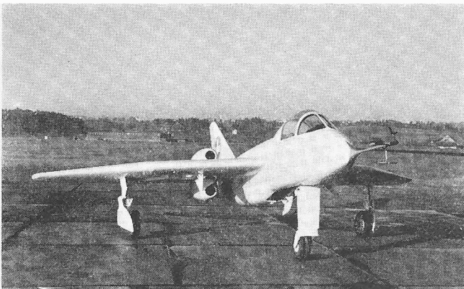
Bild 10. N-20.2 «Arbalète» auf dem Flugplatz in Emmen. Die Rumpfspitze ist mit verschiedenen aerodynamischen Messgeräten ausgerüstet
