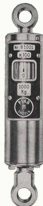
Das ist ein PIAB-Dynamometer Typ B, ein Instrument in «Taschenformat», welches Gewichte oder Kräfte bis 1000 kg misst.
