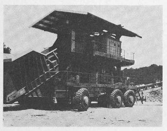
hat. Der Antrieb erfolgt über Hydraulikmotoren in den Radnaben und Planetengetriebe. Die Fahrgeschwindigkeit beträgt 700 m/h. Ausser für Kurvenfahrt lassen sich die einzelnen lenkbaren Räder auch für Schräglauf um 15° einstellen. Die gesamte Anlage hat eine installierte Leistung von 700 kW.
