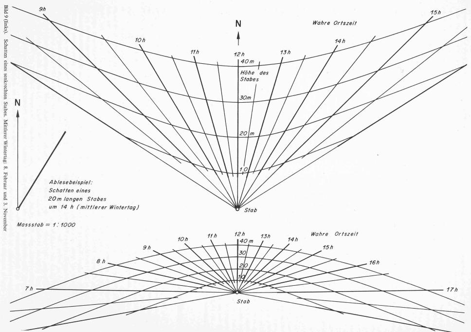
bestimmt ist, den Geländeschnitt aufzeichnen und in dieser Ebene den Durchstosspunkt des Sonnenstrahls, der durch den höchsten Punkt der Hauskante geht, konstruieren. Durch schrittweises Vorgehen können wir auch ohne die Darstellung von Geländeschnitten diesen Durchstosspunkt finden. In Bild 8 ist diese Konstruktion für den obersten Punkt der Hauskante A mit einer Meereshöhe von 830 m gezeigt:
