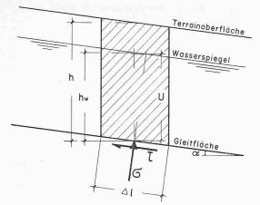
Bild 7. Hangparallele Rutschung mit ebenfalls hangparalleler Wasserströmung
