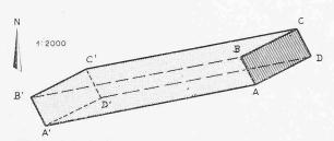
Bild 2. Schatten eines 20 m hohen Gebäudes mit dem Grundriss A-B-C-D um 6 h am mittleren Sommertag
