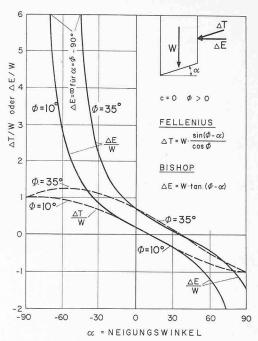
Bild 9. Einfluss der Neigung der Lamellenseitenkräfte auf die Stabilität in Abhängigkeit der Gleitflächenneigung. Besonders grosse Divergenz bei grossen negativen  $\alpha$ -Werten. Die Annahme von horizontalen Seitenkräften gibt dort zu hohe Sicherheiten!
