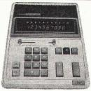
Canon L 1000, das ideale Gerät für sämtliche Rechenprobleme. 10 Stellen, kombiniertes Fliess-Fest-Kommasystem, automatische Aufund Abrundungen, %-Taste, konstanter Faktor und Einzelkorrektur.
