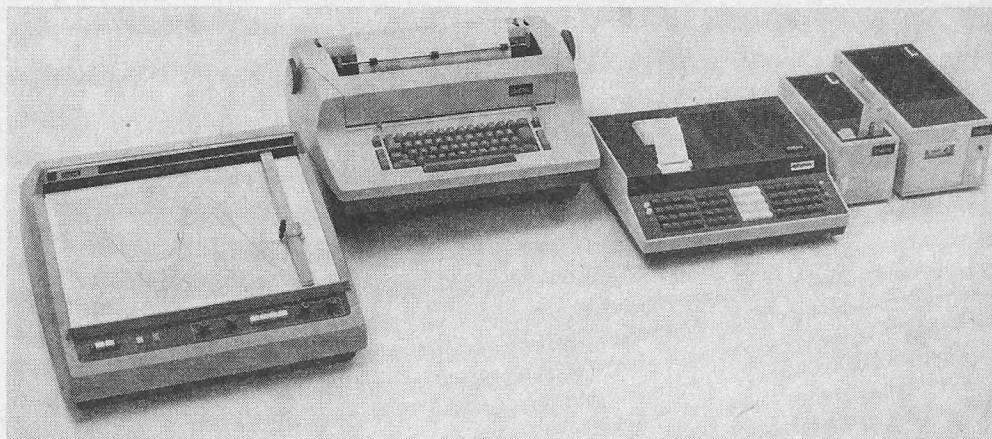
Von links nach rechts: X/Y-Plotter, Schreibmaschine für Input bzw. Output, Zentralrechner Diehl Alphatronic, Magnetkartenleser und Magnetbandstation
