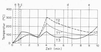
Bild 7. Deckentemperatur gemäss Versuch 2 [4], Bern, mit offener Zündung aussen verschütteten Benzins. Sonde T 1 in 12 m Abstand vom Versuchsplatz; Sonde T2 in 9 m Abstand; Sonde T3 in 10 m Abstand und hinter dem Wasservorhang. a nach 21 s Feuermelder angesprochen; b nach 40 s Sprinkler ausgelöst; c nach 50 s Wasservorhang ausgelöst; d nach 6 min 30 s Wasservorhang abgestellt; e nach 9 min Sprinkler abgestellt
