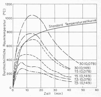
Bild 5. Raumtemperaturen bei unterschiedlichen Brandbelastungen und Oeffnungsfaktoren [13]. 30 (0,078) bedeutet: Brandbelastung 30 kg Holzgleichwert/m² mit einem Oeffnungsfaktor Aw  $\sqrt{h/At} = 0,078$ ; Aw = Gesamtfläche aller Oeffnungen in m²; <math>h = mittlere Höhe der Oeffnungen in m; At = Gesamtfläche des Brandabschnittes in m²
