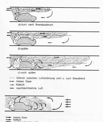
Bild 8. Rauch- und Luftströmung bei einem Brand in einem Raum geringer Bauhöhe. a kurz nach Brandausbruch; b später; c noch später; d bei ausgelöster Sprinkler-Anlage
