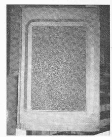
Bild 6, rechts. Vorgefertigte Fassadenplatte aus Glasfaserbeton mit Waschbeton-Vorsatzspiegel (80 kg), ausgeschalt nach 24 Stunden
