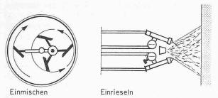
Bild 3. Herstellverfahren für Glasfaserbetone (GFB)
