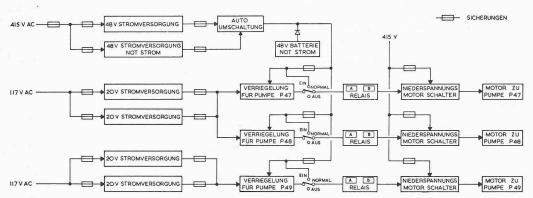
Bild 6. Stromversorgung – Motorsteuerung
