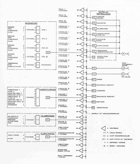
Bild 10. Aufbau der Kommunikationsanlage
