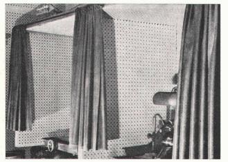
Schalldämmvorhänge für Schleifkabinen
