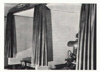
Schalldämmvorhänge für Schleifkabinen
