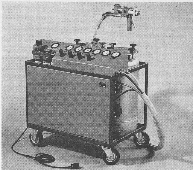
Frontansicht der im Baukastensystem konstruierten Dosier- und Mischmaschine DG-103. Im Vordergrund ist das Bedienungspult sowie ein Teil des Luftaufbereitungsaggregates sichtbar. Dahinter stehen zwei Material-Druckbehälter von je 36 l Inhalt sowie ein Druckbehälter für das Spülmittel mit 20 l Inhalt. Darüber ist die angeschlossene Spritzpistole mit den Zuleitungen sichtbar.
