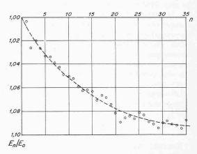
Bild 7. Vergrösserung des Elastizitätsmoduls E eines Invardrahtes infolge mehrmaligen Auf- und Abrollens des Drahtes (n = Anzahl Umspulungen)
