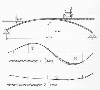
Bild 14. Gemessene Horizontal- und Vertikaldeformationen u und v für drei parallel liegende Messquerschnitte im Feld A (Lastfall 1)
