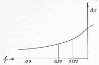
Bild 9. Gemessene Änderung des Durchmessers  $\triangle d$  in Funktion des Abstandes des Messquerschnittes von der Ortsbrust
