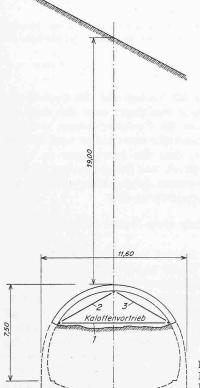
Bild 10. Anordnung der Messlängen 1, 2 und 3 im Kalottenprofil (Bächwaldtunnel)
