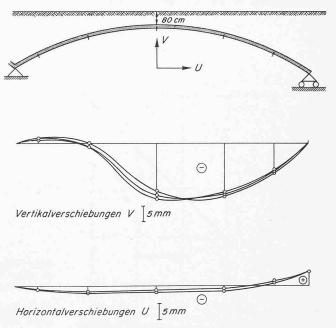
Bild 15. Gemessene Horizontal- und Vertikaldeformationen u und v für drei parallel liegende Messquerschnitte im Feld A (Lastfall 2)
