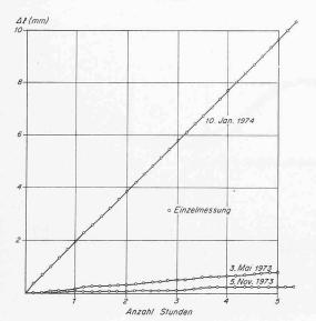
Bild 17 (links). Ergebnisse der Deformationsmessungen an einer Messstrecke im Felsrutschgebiet Schafbett-Amden (Felsabsturz am 21. Januar 1974)
