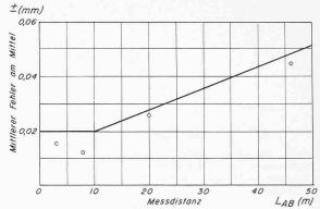
Bild 6. Mittlerer Fehler am Mittel der Ablesungen in Funktion der Messlängen  $L_{\rm AB}$
