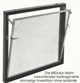
Kosten. Die Rahmen sind aus einem Stück Polyurethan (ein Hartintegralschaumstoff, der genagelt werden kann) gefertigt. Die Glaskippflügel sind mit einer Luftpolsterdichtung versehen. Da Polyurethan kein Wasser aufnimmt, ist jedes Verziehen oder Verquellen ausgeschlossen. Der Glaskippflügel lässt sich mit handlichen Drehgriffen leicht bewegen. Wir liefern MEAdur-Fenster in 4 Grössen mit Einfachoder Isolierverglasung. Auf Wunsch mit Mäuse- oder Stabgittern
