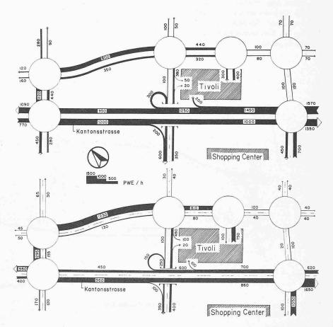
Bild 6. Verkehrsprognose für das Spreitenbacher Strassennetz nach der Eröffnung des Tivoli. Oben: werktags von 17 bis 18 h. Unten: von 19 bis 20 h im Winter bzw. von 20 bis 21 h im Sommer
