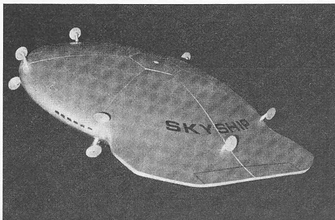
Corporation in einem Windkanal geprüft. Die Maschine ist hauptsächlich als Schüttgut-Transporter gedacht und erfordert keine größeren Bodenanlagen. Sie eignet sich zur Beförderung der verschiedensten Frachtgüter, wie Container oder Kraftwagen und könnte auch für den Personenverkehr eingesetzt werden.
