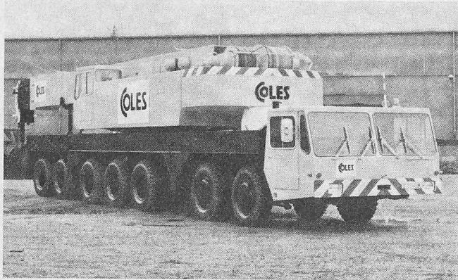
gesteuert werden und horizontal und vertikal unabhängig verstellbar sind. Die geräumige vierplätzige Frontlenkerkabine ist schallgedämpft und schwingungsfrei auf Gummielementen gelagert. Die Abmessungen, Achslasten, Bremsysteme und Beleuchtungsorgane entsprechen den heute gültigen Normen und Vorschriften für schwere Arbeitsmaschinen.
