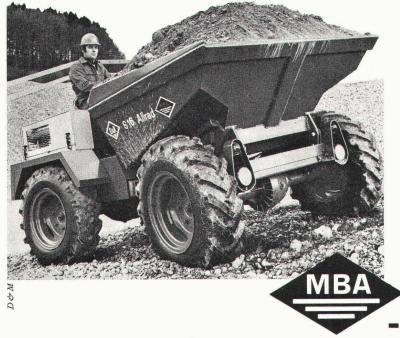
Ausgezeichnete Geländegängigkeit dank Allradantrieb, Wendegetriebe und 24,5-PS-Dieselmotor. Erstaunliche Manövrierfähigkeit durch hydraulische Knickrahmenlenkung. Wendekreis 1,65 m. Muldeninhalt 1,6 m³ und 2,5 Tonnen Nutzlast. Grosses Ausrüstungsprogramm für jeden Einsatz.
