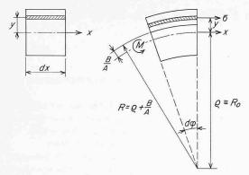
Bild 3. Element eines auf Biegung beanspruchten Balkens mit den im Text verwendeten Bezeichnungen. x= Achse durch den Schwerpunkt des Balkenquerschnittes.  $\rho=$  Schwerpunktabstand vom Krümmungsmittelpunkt. R= Abstand der neutralen Faser vom Krümmungsmittelpunkt.  $R-\rho=$  Verschiebung der neutralen Faser infolge veränderlichen E-Moduls
