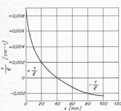
Bild 9 (links). Biegemoment und Reziprokwert des Biegeradius in Abhängigkeit von der halben Balken-
