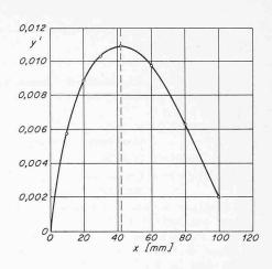
Bild 10 (rechts). Durch ein- bzw. zweifache Integration ermittelter Verlauf der Neigung und der Form der neutralen Linie in Abhängigkeit von der halben Balkenlänge
