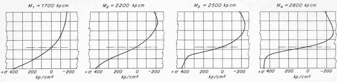
Bild 7. Die berechneten Spannungen in Abhängigkeit vom Biegemoment
