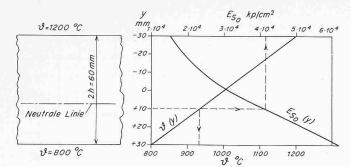
Bild 5. Angenommene Verteilung der Temperatur und des  $E_s$ -Moduls beim Zahlenbeispiel im Anhang
