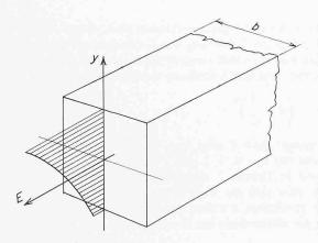
Bild 1 (links). Verteilung des E-Moduls über die Balkenhöhe, wie sie z. B. durch ein instationäres Temperaturgefälle hervorgerufen wird
