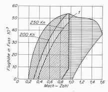
Bild 4. Manövrierklappen am Tragflügel. Links Klappenstellungen, rechts Geschwindigkeits- und Flughöhenbereiche der Klappenstellungen. 1 Geschwindigkeitsbegrenzung für den Flug mit ausgefahrenen Klappen
