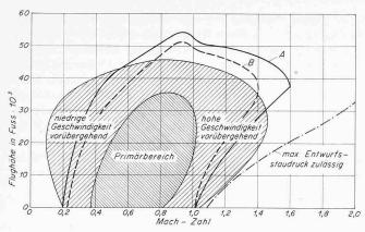
Bild 3. Manövrierkampfbereich der F-5E. Fluggrenzkurven für:
