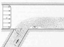
Bild 3. Einseitige Rückgabe in Sohlennähe quer zur Strömungsrichtung
