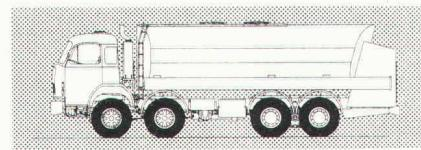
Tankwagen, Radstand 2900 mm, mit Brennstoffzisterne in Kofferform; Inhalt ca. 21000 l
