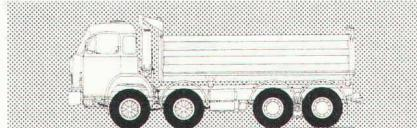
Muldenkipper, Radstand 2400 mm, mit Rückwärtsskippmulde aus Leichtmetall, Inhalt ca. 10 m³, Innenlänge 5000 mm. Nutzlast ca. 16500 kg bei 28000 kg, bzw. ca. 18 500 kg bei 30 000 kg Gesamtgewicht.
