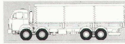
Lastwagen, Radstand 4000 mm, mit Ladefläche, Innenlänge max. 9200 mm, Nutzlast ca. 17000 kg
