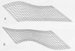
Bild 6. Eigenvektoren einer schiefen Plattenbrücke mit zwei Stützen a Erste Eigenschwingung b Zweite Eigenschwingung
