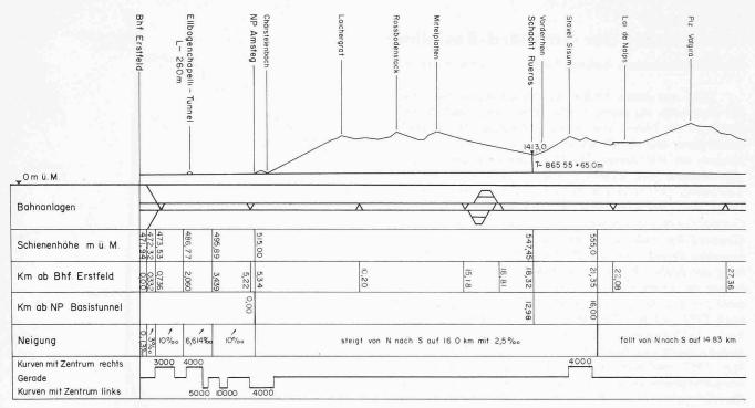
Bild 2. Längenprofil und Gleisschema der Basislinie Erstfeld-Giustizia, S Biasca, Projekt 1972
