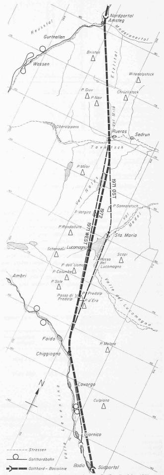
Bild 1. Trasse des Basistunnels Amsteg-Bodio, Projekt 1972; zum Vergleich die Trassevarianten Ost und West des Projektes 1971
