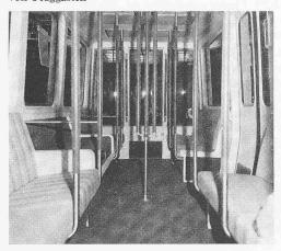
Bild 8. Airtrans-Fahrzeug, vorne Notausstiegtür, rechts unten die Signal- und Stromabnehmerbürsten am Fahrzeug
