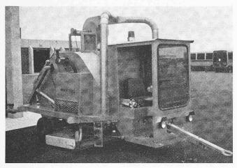
Bild 10. Fegemaschine zum Säubern des U-förmigen Betonfahrweges
