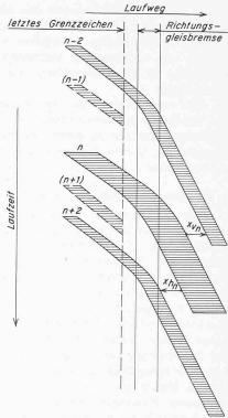
Bild 1. Prinzip des «optimalen Einfädelns» im Richtungsgleis
