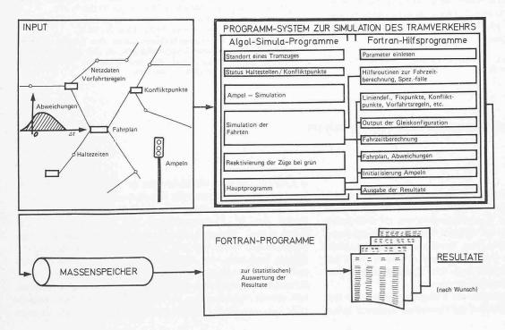
Bild 1. Programmstruktur des Programms zur Simulation des Tramverkehrs
