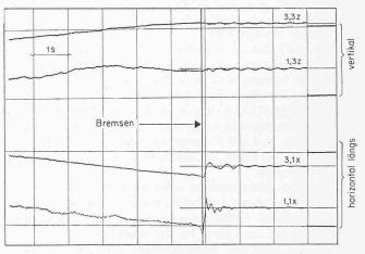
Bild 3. Messdiagramm der Kräfte beim festen Auflager
