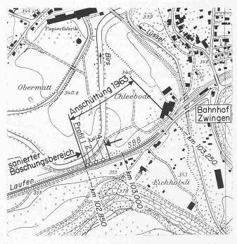
Bild 1. Lageplan 1:10 000 mit dem Bahnhof Zwingen und saniertem Bahntrasse. Reproduziert mit Bewilligung der V+D vom 28. 12. 1972
