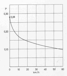
Bild 4. Bremskraft in Abhängigkeit der Geschwindigkeit
