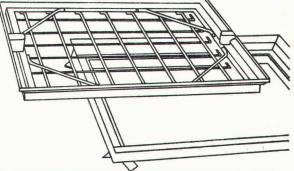
Für den Bauausführenden: Keine Probleme beim Einbaul Die Nenngrössen passen sich entweder den verschiedensten Plattenformaten von Fussbodenbelägen an oder weisen den Vorschriften entsprechende Mauermasse für die lichte Schachtweite auf.
