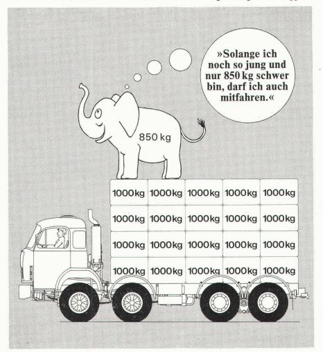
Da spitzt der kleine Elefant seine grossen Ohren, wenn er hört, dass er und noch zwanzig Tonnen auf dem Saurer-Berna-Vierachser transportiert werden können. So gross ist die Chassistragfähigkeit beim fabrikgarantierten Gesamtgewicht von 30 Tonnen. Unser Elefant weiss aber, dass der Gesetzgeber auf öffentlichen Strassen nur deren 28 gestattet.
