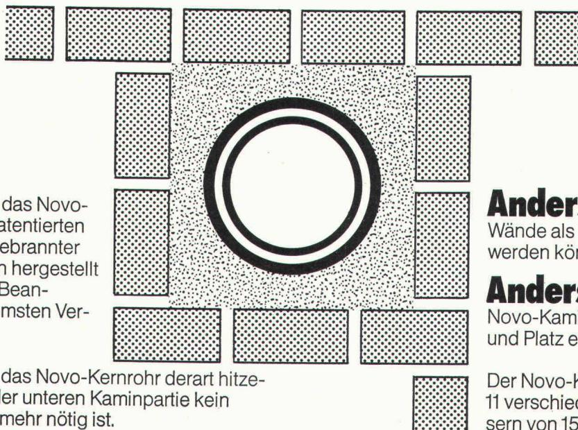
**Anders, weil** das Novo-Kaminrohr aus einer patentierten Mörtelmischung von gebrannter Erde im Pressverfahren hergestellt wird und deshalb den Beanspruchungen bei extremsten Verhältnissen standhält.
