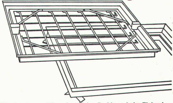
**Für den Bauausführenden:** Keine Probleme beim Einbau! Die Nenngrößen passen sich entweder den verschiedensten Plattenformaten von Fußbodenbelägen an oder weisen den Vorschriften entsprechende Mauermasse für die lichte Schachtweite auf.
