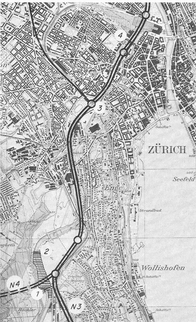
Bild 1. Lageplan 1:34 000 mit Sihlverbauungen im Stadtgebiet von Zürich. 1 Höcklerbrücke, 2 Gänziloobrücke mit Stauwehr, darüber Eisretentionsbecken, 3 Sihlhölzli, 4 Postbrücke (Reproduziert mit Bewilligung der Eidg. Landestopographie vom 27. 7. 1970)
