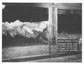
Bild 12. Für das Unterströmen der Faltschütze gefährlicher Stauspiegel wegen möglichen Mitreissens von Eisschollen in die untere Schützenöffnung
