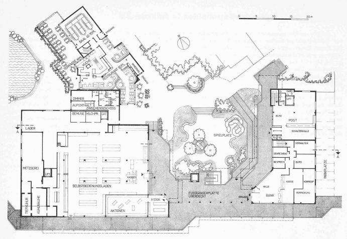
Grundriss des Zentrums, Fussgängerplatte mit Selbstbedienungsladen, Bank und Post, im Erdgeschoss Restaurant mit Saal
