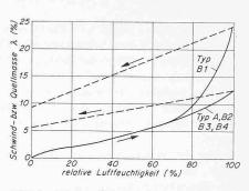
Bild 4. Mittlere Schwind- bzw. Quellmasse in der Plattendicke
