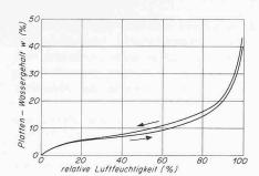
Bild 2. Mittlere Wasserdampf-Sorptionsisothermen für  $t=20~{\rm ^{\circ}C}$
