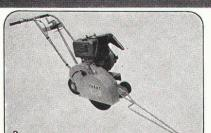
2 Beton- und Asphaltfräse. Entfernt Verkehrsmarkierungen, ohne die Unterlage zu beschädigen, schneidet Fugen für Verkehrsmarkierungen, rauht Böden auf, entfernt Betonschlemme.
