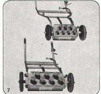
8 Betonboden-Aufrauhgerät. Für die Erstel-lung von Haftbrücken auf Betonober-flächen. Erhöht die Haftfestigkeit der Beschichtungen. Entfernt schadhafte Beläge. Korrigiert Überhöhungen. Macht Beton-flächen eben, griffig, hart, frei von Graten, Nestern, blättrigen und mürben Schichten. Mit unglaublicher Leistung, sauber, cm² für cm². Für Strassen, Pisten, Plätze, Keller, Industrieböden, Brücken, Balkone
