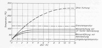
Bild 5. Motorerwärmung bei verschiedenen Betriebszuständen
