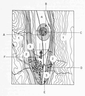
Fig. 3. Bassin d'alimentation d'une nappe souterraine, avec ses zones de protection:
