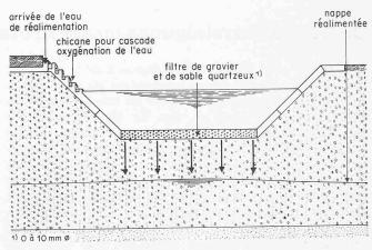
Fig. 10. Coupe schématique d'un bassin de réalimentation
