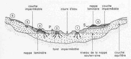
Fig. 2. Cas de pollution de la nappe aquifère par une exploitation et un comblement inadéquat de gravières (voir légende dans le texte)
