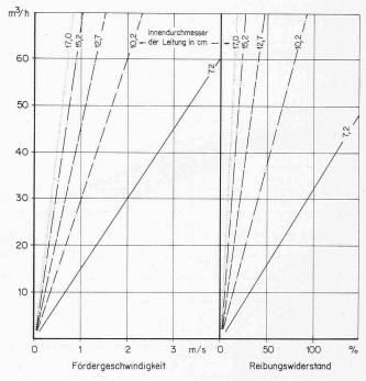
Bild 4 und 5. Links. Fördergeschwindigkeit in Abhängigkeit von Förderleistung und Innendurchmesser der Leitung
