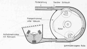
Bild 3. Schematische Darstellung der Squeezerdruckpumpe
