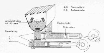
Bild 2. Schematische Darstellung der Kolbenpumpe
