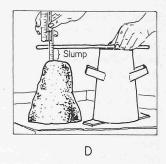
Bild 9. Prüfung der Betonkonsistenz mit Hilfe des Slumptestes (ASTM Norm C 143-69)
