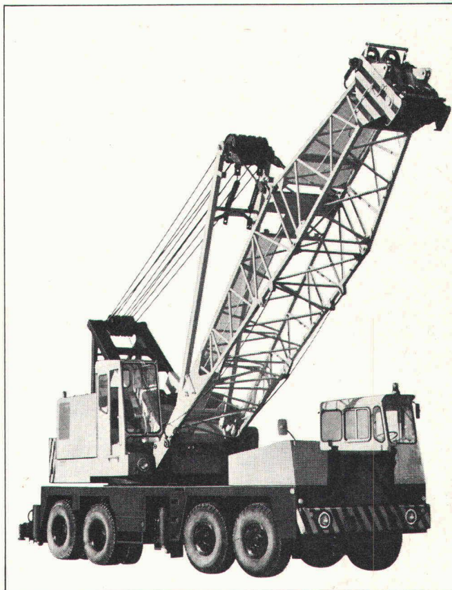
Dieselelektrischer COLES-Autokran Modell Gargantua
