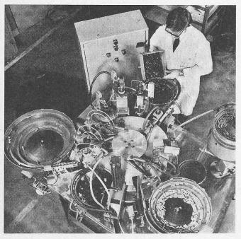
Durch diese Einheit wird eine Taktbewegung mit gesteuerter Beschleunigung und Verzögerung gewährleistet, die für diese Zusammenbauvorgänge von ausschlaggebender Bedeutung ist.
