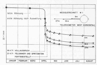
Bild 3. Zeitlicher Verlauf der Felsdeformation im Messquerschnitt 1 bei Tunnelkilometer 95,277 (vergleiche Bild 1 in [4], dort mit M 2 bezeichnet)
