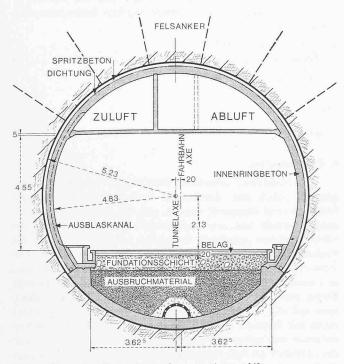
Bild 1. Normalprofil des Sonnenbergtunnels, aus [4]
