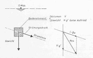
Bild 5. Vektorielle Addition von Gewicht und Strömungsdruck
