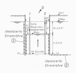
Bild 13. Hydraulischer Grundbruch: a) Boden homogen und isotrop
