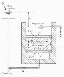
F.P.: Filterplatten kFP ≫ kBoden! Gesetz von Darcy:  $V = k \cdot i$
