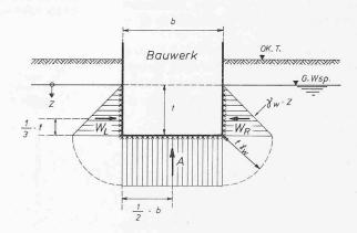
Wasserdruck links ( $W_L$ ) = Wasserdruck rechts ( $W_R$ )  $W_L = W_R = \frac{1}{2} \cdot t \cdot t \cdot g_w = \frac{1}{2} \cdot t^2 \cdot g_w \qquad \text{Auftrieb A = b \cdot t \cdot g_w}$   $pro \ m' \ Lange \ des \ Bauwerkes$
