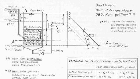
Bild 4. Ermittlung des Srömungsdruckes i  $\gamma_w$  (Schema);  $\gamma_g$  Raumgewicht im gesättigten Zustand
