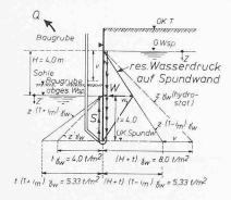
Linearer Druckabbau entlang Stromröhre S
