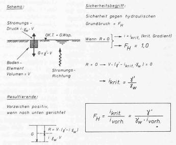
Bild 11. Einführung des Sicherheitsbegriffes gegenüber hydraulischem Grundbruch. Senkrecht nach oben gerichtete Sickerströmung
