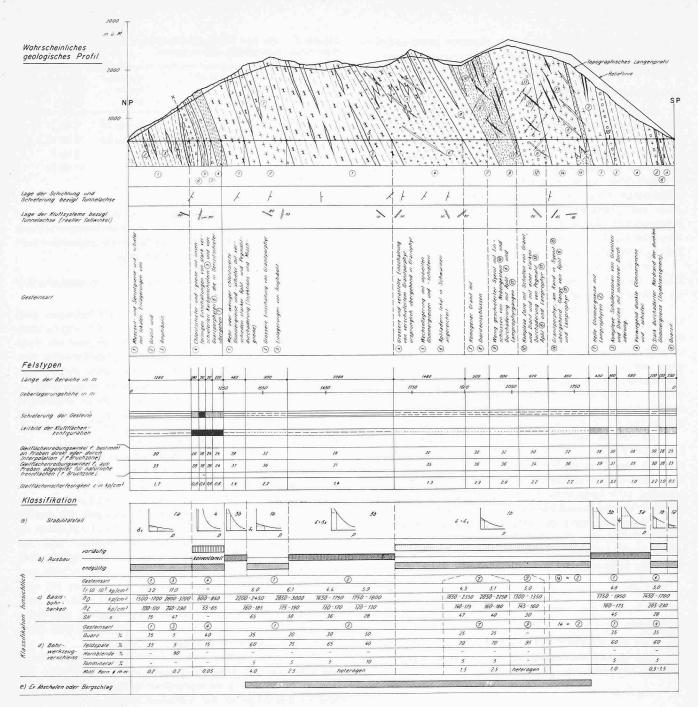
Bild 8. Felstypen-Längenprofil und Klassifikations-Längenprofil eines Tunneltrasses auf der Grundlage des wahrscheinlichen geologischen Profils, Bohrdurchmesser  $D=4,2\,\mathrm{m}$
