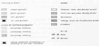
Diese drei Oberklassen sind in *Unterklassen* zu gliedern. Diese sind definiert durch die Art, das Ausmass und den Ort bzw. den Zeitpunkt des Einbringens des ersten Ausbaues beim Vortrieb des Tunnels. Für die 1. und 2. Oberklasse werden diejenigen Verfahren, die unter Voraussetzung einer zweckmässig konzipierten und mit Ausbauhilfen ausgerüsteten Vortriebsmaschine beim Vortrieb zu keinen oder ungefähr zu gleich langen nicht systembedingten Stillstän-
