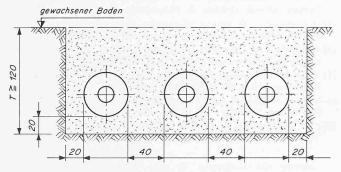
Bild 3. SF<sub>6</sub>-isoliertes Rohrgaskabel, einphasige Ausführung
