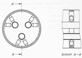
Bild 4. Dreiphasiges Rohrgaskabel, Bauart Brown, Boveri
