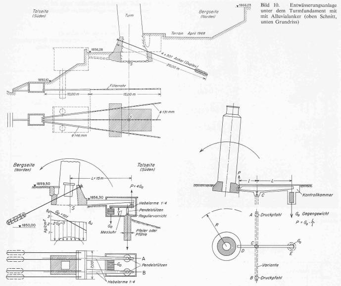
Bild 11. Massnahmen zur Wiederaufrichtung (vollständiger oder teilweiser) schiefer Türme am Beispiel des Schiefen Turms von St. Moritz
