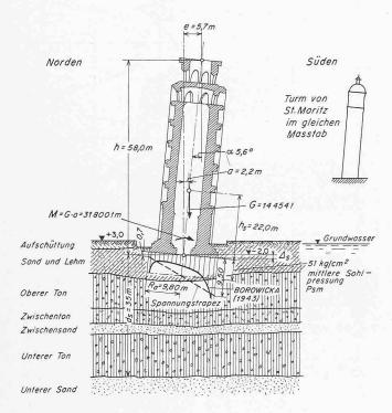
1967: Unter Berücksichtigung der stärkeren Neigung des Turmes (9,4%) und Winddruck (100 kg/m²) lassen sich nachstehende Bodenpressungen nachweisen:  $\sigma_o = 1.5 \text{ kg/cm}^2$ ;  $\sigma_u = 2.9 \text{ kg/cm}^2$ .
