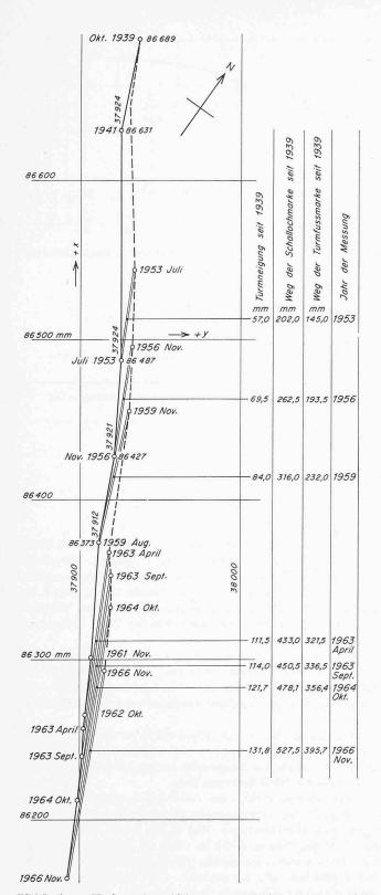
Bild 5, oben. Horizontalverschiebungen und Neigungen des Schiefen Turmes von St. Moritz ab 1939
