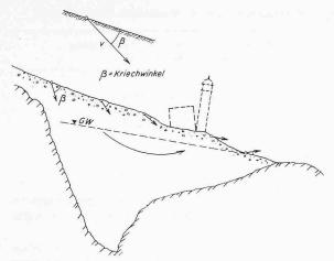
Bild 3. Geländequerschnitt Nord-Süd (Kriechvorgänge)
