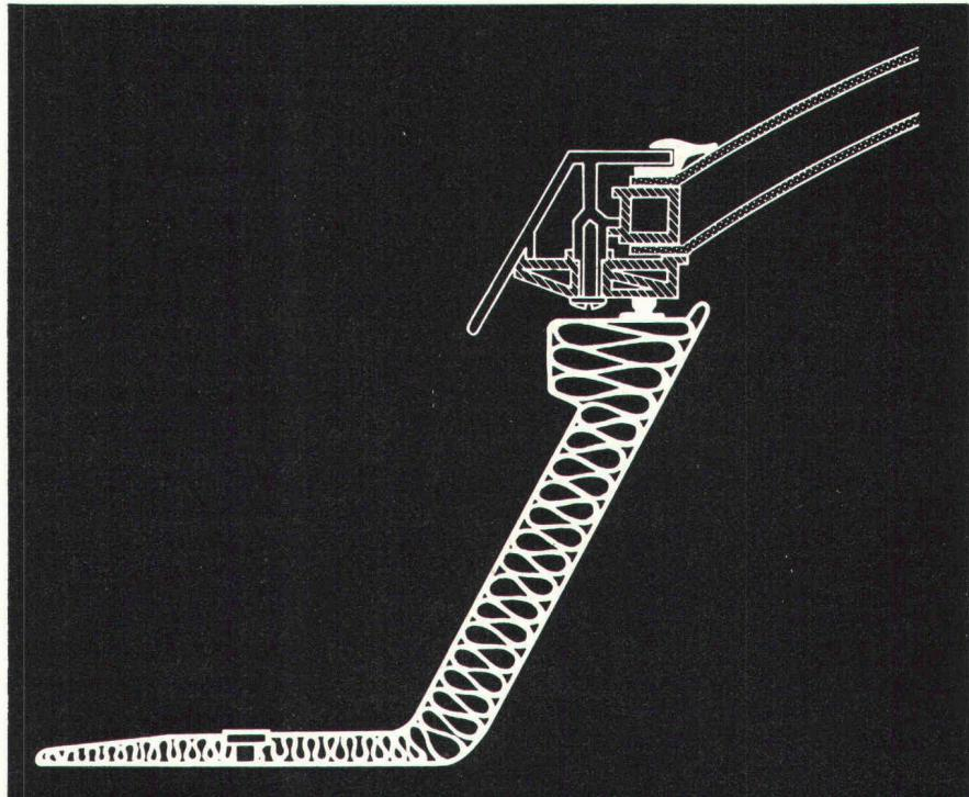
CUPOLUX-Lichtkuppeln sind montagefertige Bauelemente, die sich jederzeit in CUPOLUX-Lüfter ändern lassen, und entstammen dem grössten Lichtkuppelwerk Europas. Konstruktion und Wahl der Werkstoffe sind das Ergebnis jahrzehntelanger Erfahrung. Die Planung von Grossserien macht auch für die Details eine ausgefeilte Ingenieurlösung möglich.
