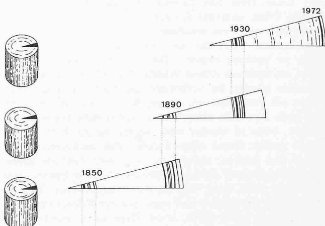
Schema der Baumring-Datierung (Dendrochronologie). Durch «Überlappen» von Proben verschieden alter Baumstämme – ausgehend von einem kürzlich gefällten Baum – ist es möglich, ältere Baumstämme – die z. B. zum Bau eines Hauses verwendet wurden – zu datieren und damit die Entstehungszeit dieses Gebäudes zu bestimmen
