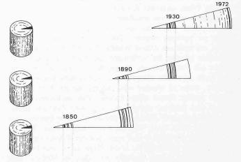
Schema der Baumring-Datierung (Dendrochronologie). Durch «Überlappen» von Proben verschieden alter Baumstämme – ausgehend von einem kürzlich gefällten Baum – ist es möglich, ältere Baumstämme – die z. B. zum Bau eines Hauses verwendet wurden – zu datieren und damit die Entstehungszeit dieses Gebäudes zu bestimmen
