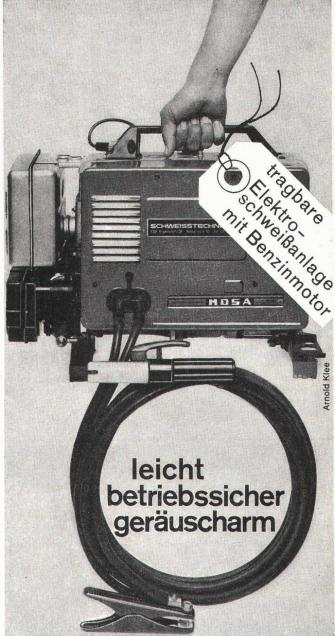
Leistungsdaten: Für Elektroschweißung. Verwendbare Elektroden: bis zu 3,25 mm. Schweißspannung: 20/30 V. Schweißbereich: bis 150 A bei 60 % ED. Wechselstrom (Frequenz von 2000 bis 2800 Hz) und Gleichstrom (mit zusätzlich lieferbarem Gleichrichter). Weitere Verwendungsmöglichkeiten (mit Zubehör nach Wahl). Mit Transformator ausgerüstet, betreibt der Apparat auch Einphasenmotoren, Bohrer, Schleifer usw., für 220 V und mit einer Leistung bis zu 2000 W. Mit Spezialkabeln ist Rohrenteisung möglich
